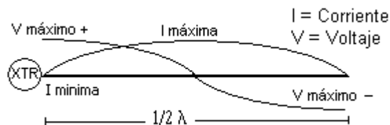
Distribución de la corriente y del voltaje a lo largo de la antena:
